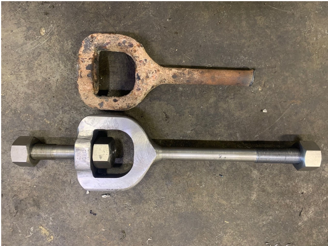
Ein fertiger Deckenanker, daneben einer aus dem Kessel der Lok 1
