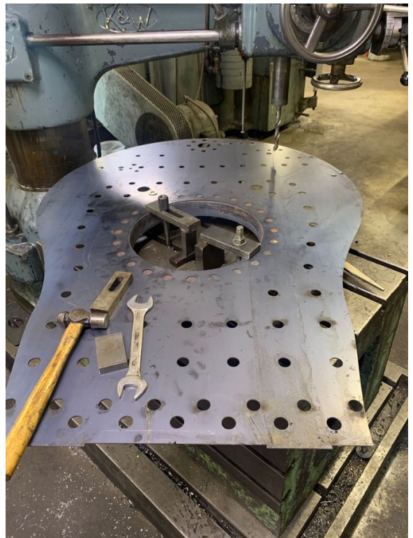
Der Feuerbüchsring ist eingienietet
