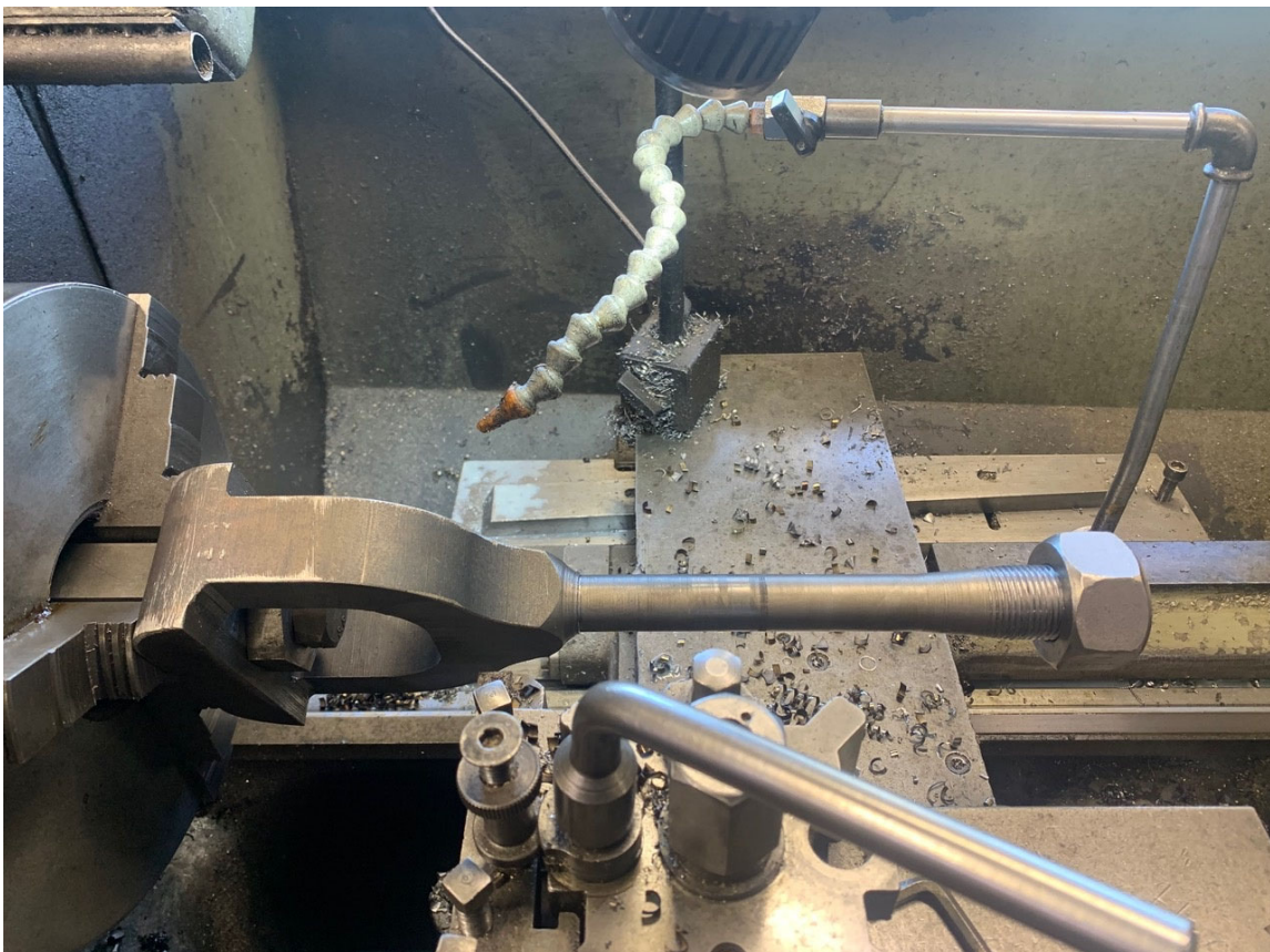
Die Aufhängung des Deckenankers mit Gewinde und Mutter
