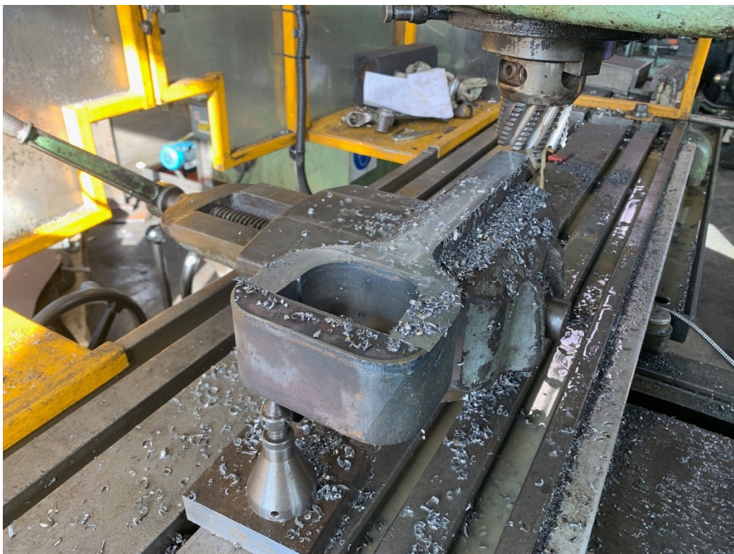
In England werden Teile für die Aufhängung der Feuerbüchse hergestellt. Die Deckenanker werden aus einem Stück gefräst
