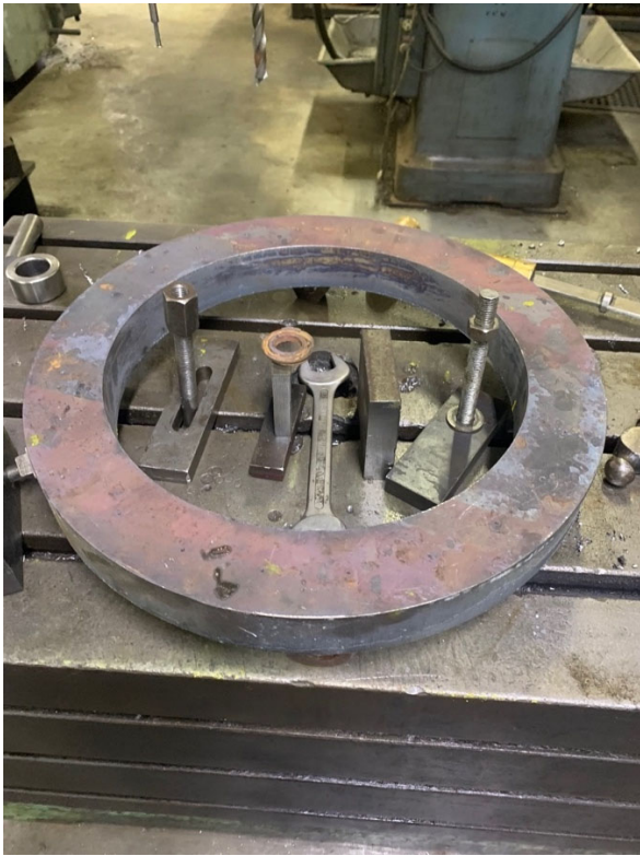
Die Rückwand mit dem fertigen Feuerbüchsring
