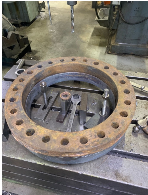
Der Feuerbüchsring ist eingienietet
