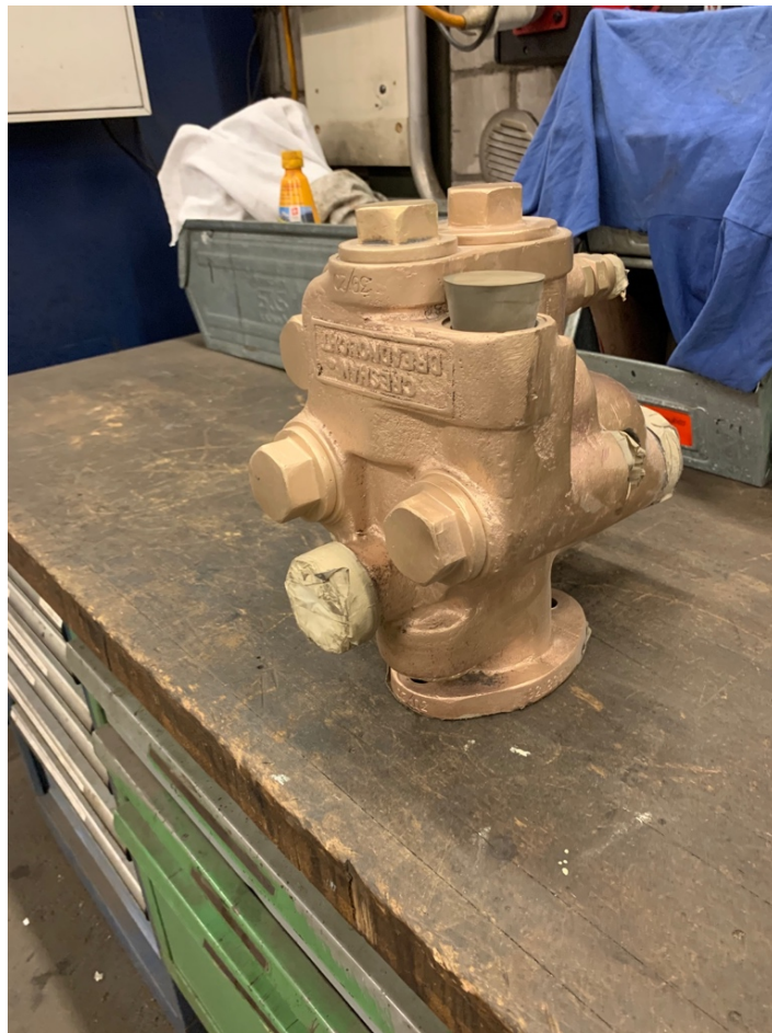
Verschiedene Rückschlagventile vom Ejektor werden revidiert
