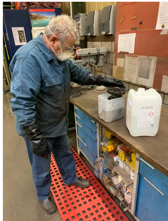
Jetzt wird der Speisekopf in Ameisensäure getan.
