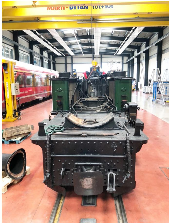
Der Rahmen mit Wasserkästen und hinten der Kessel
